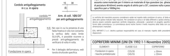
\* Prevedere uno scavo maggiorato di una misura non inferiore a 0,5m e non superiore a 1m per ogni lato della vasca. Al fine del calcolo delle sponde, è stato assunto come materiale per il riporto un materiale di tipo granulare (es. ghiaia di peratura 40-60mm) avente angolo di attrito pari a 35°, coesione nulla e peso specifico pari a 1800kg/mc.
